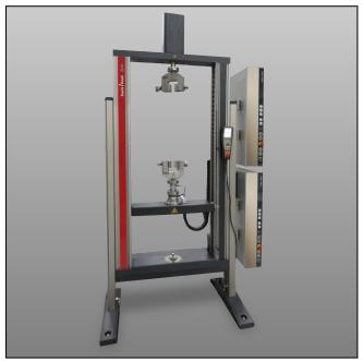
Tisch-Prüfmaschine mit Torsionsantrieb auf Kopftraverse
