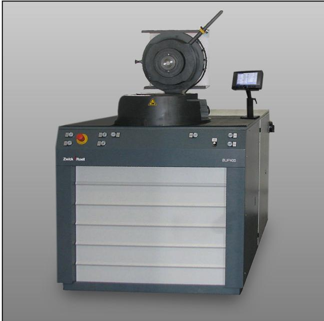
Blechumform-Prüfmaschine BUP 600
