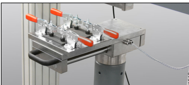
Amsler HIT230F, Verschiebeeinheit für CAI-Klemmvorrichtung
